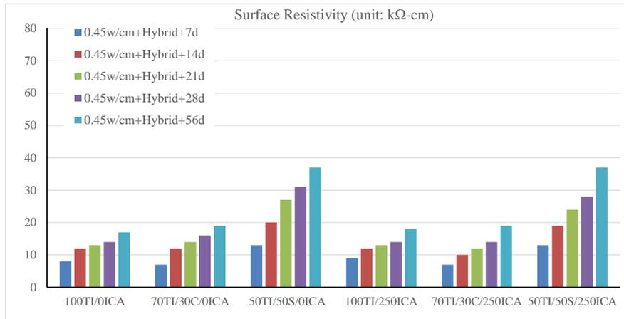
(d) Surface resistivity for 0.45 w/cm + 100% RH curing
