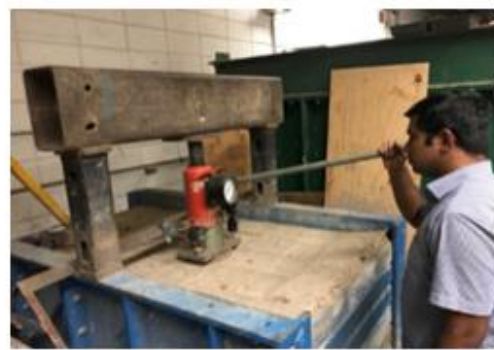
(d) Plate load test
