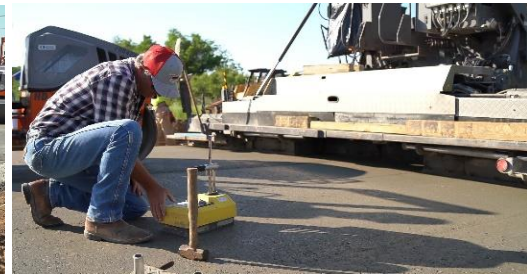
(d) In-field density measurement
