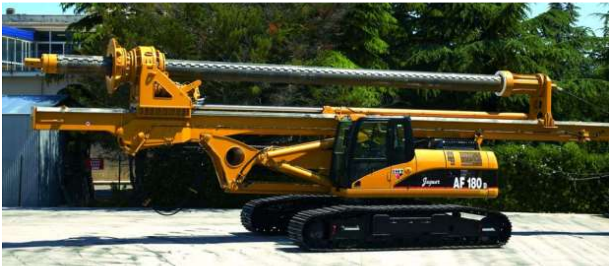
Figure 54 AF 190/ AF 180D drilling rig
